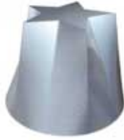
4-Achsen-Schnitt Verknüpfung unterschiedlicher Geometrien
