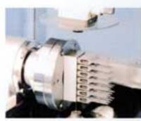
Ob Standard-Spannfutter oder individuelle Vorrichtung: Wir haben die Lösung! Die optional erhältliche horizontale B-Achse erlaubt echte 6-Seiten-Bearbeitung in einer einzigen Aufspannung.
