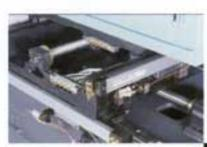
Das direkte Wegmeßsystem über hochpräzise Glasmaßstäbe garantiert höchste Genauigkeiten am Werkstück.
