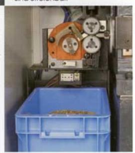
Der serienmäßig integrierte Drahtchopper trennt den verbrauchten Draht ruckfrei in kleine Abschnitte. Das Entsorgungsvolumen wird deut-lich reduziert.
