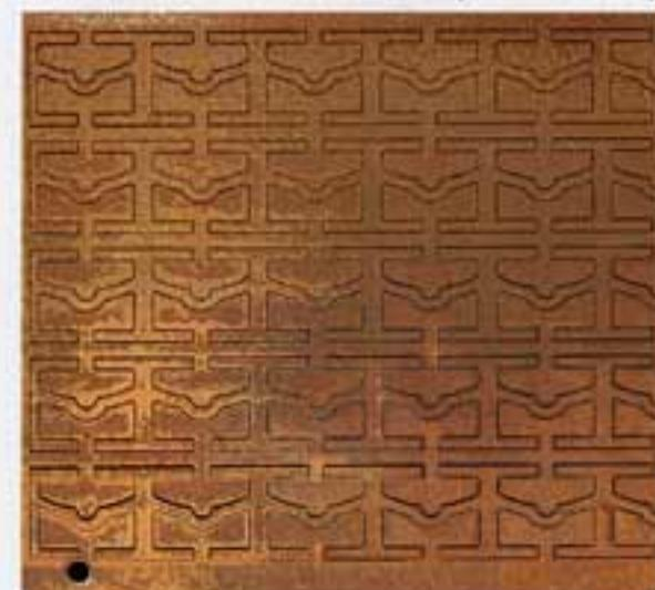
Beim elektrolysefreien Schneiden wird verhindert, daß Kobalt in Lösung geht. Bei Wolframkarbid-Verbindungen wird Kobalt als Bindemittel benutzt. Damit bleibt die Ursprungsfestigkeit des Ausgangsmaterials erhalten.
