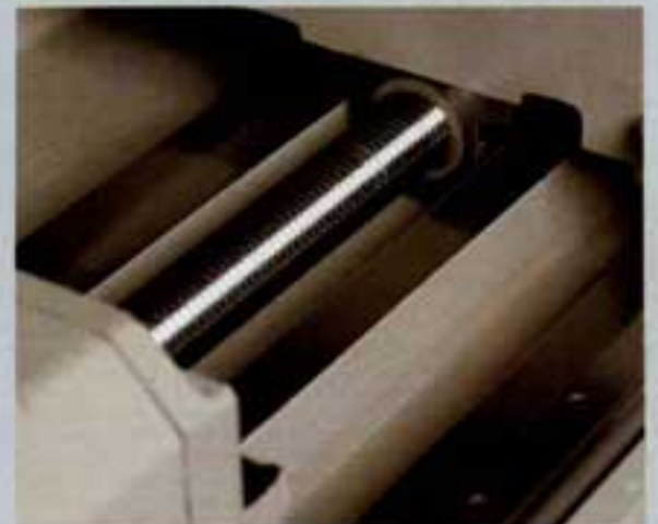
Super-Präzisions-Kugelrollspindel großen Durchmessers.
