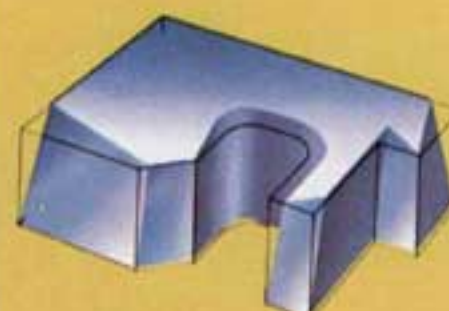
Kontinuierliche Schneidwinkeländerung beim Konischschneiden
