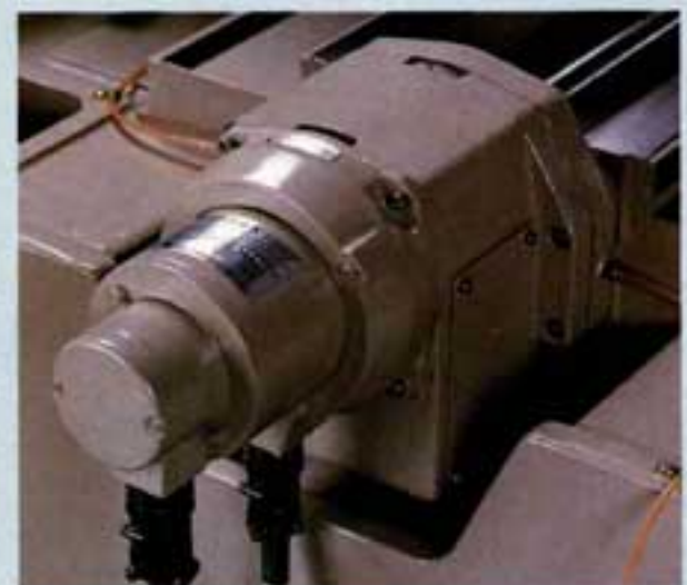
Optimal ausgelegte DC-Servo-Motore als Tisch-Antriebe für ruhigen, stabilen Lauf.
